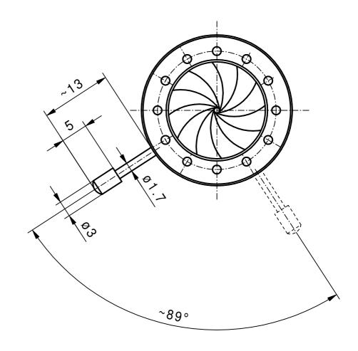
min.Apertur ~ ø1,0mm Gewinde Hebel M1,7
