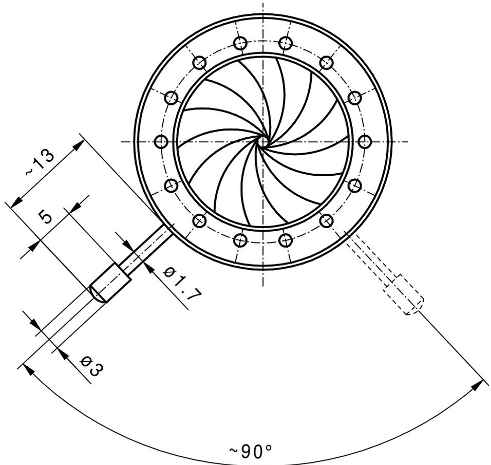
min. Apertur ~  $\varnothing 1,5\text{mm}$
