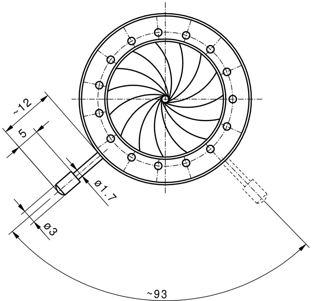
min.Apertur ~  $\varnothing 1,5\text{mm}$
