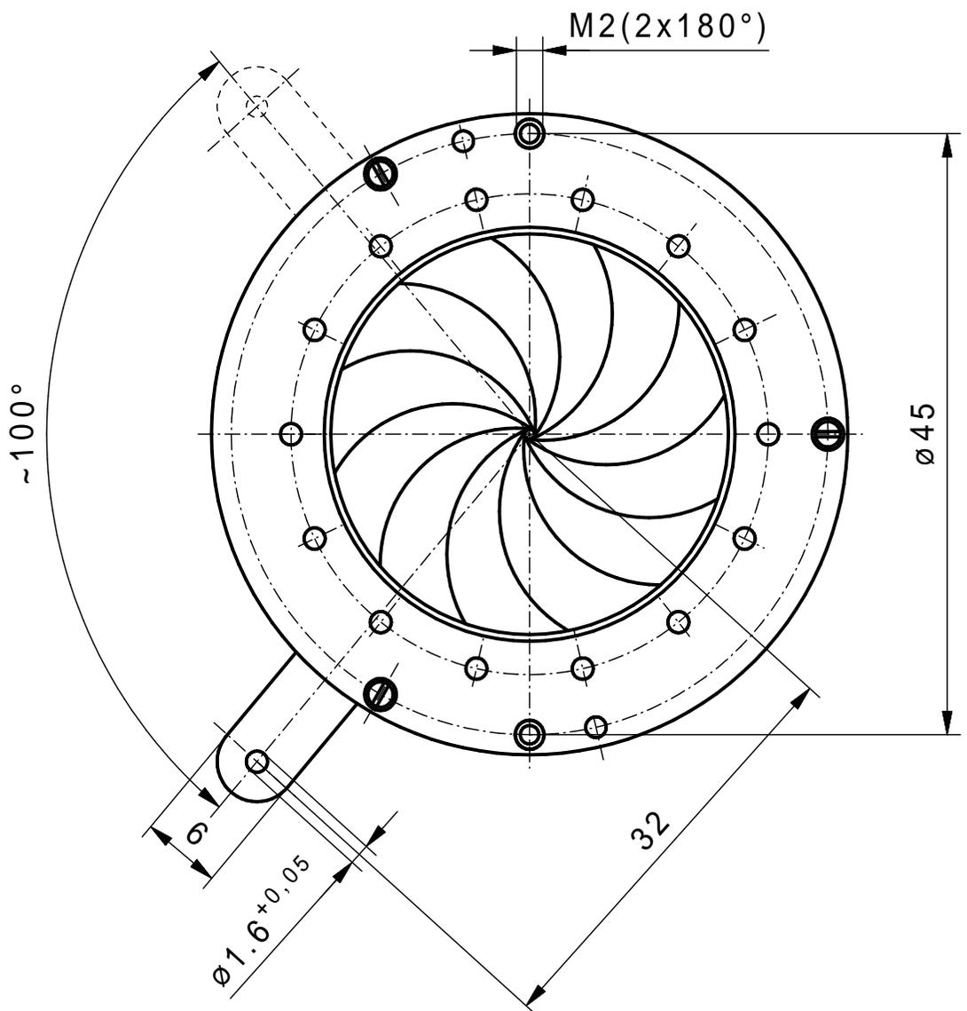
min. Apertur  $\varnothing 1,5 \text{ mm}$
