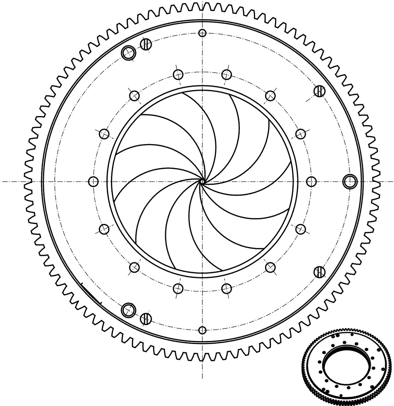
Drehwinkel ca.  $96^\circ$  min. Apertur  $\varnothing 2,0$  mm
